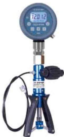
ПДЭ-010И, установленный на помпу ЭЛЕМЕР-РВ-60
