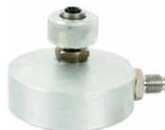
Б-1-М20×1,5 настольный блок-основание для датчика давления.
